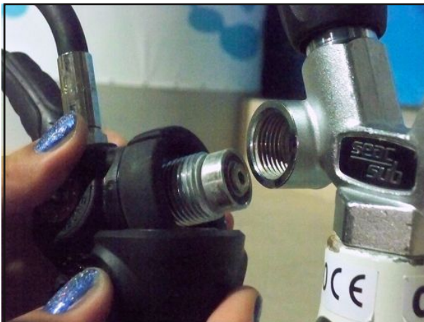
DIN fitting - tank valve, no O ring
